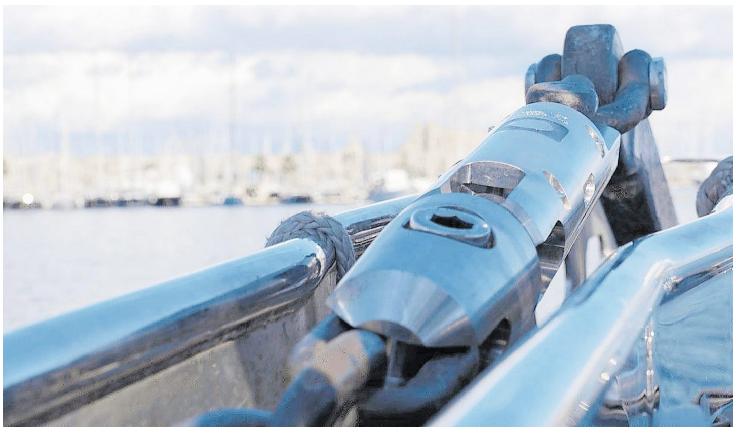
Der AnchorGuardian, mit dem Swiss Ocean Tech das Ankern sicherer macht, wird als Zwischenglied an die Ankerkette gehängt. Bild: zvg
